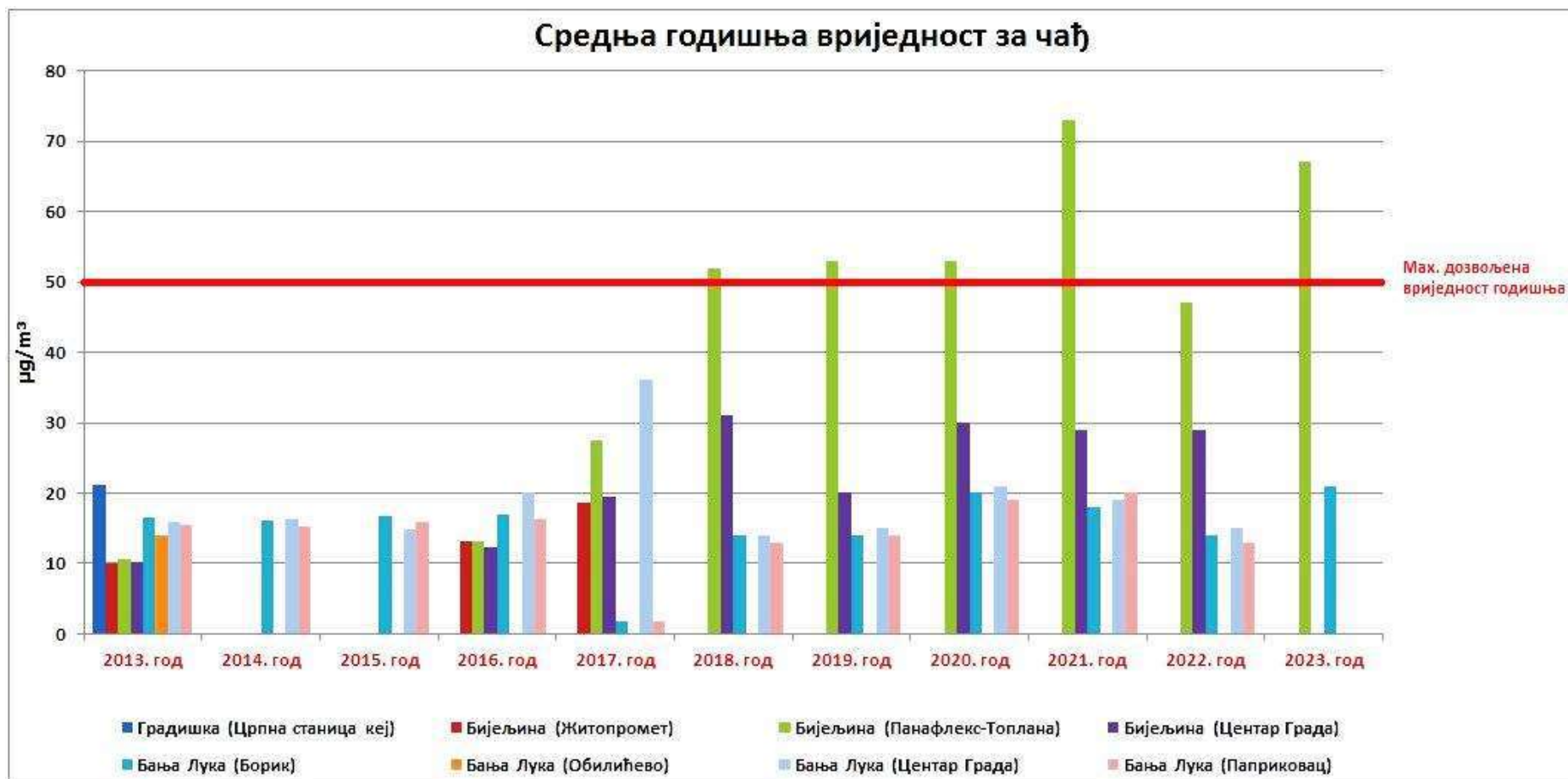
Графикон 49. Упоредни приказ средњих годишњих вриједности чађ-и \mu\text{g}/\text{m}^3 по мјерним мјестима и годинама
